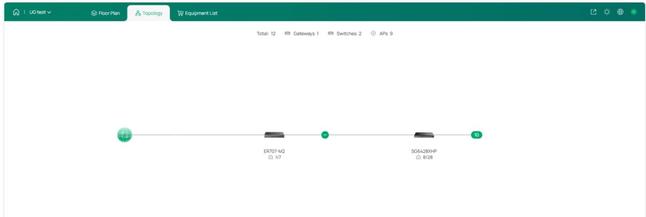
Disconnected 장치가 존재할 경우 페이지 상단에 알림이 표시됩니다. 경고 알림을 클릭하면 Disconnected 장치 목록을 확인할 수 있습니다. 아이콘( ⓘ )을 클릭하면 평면도에서 해당 장치를 찾을 수 있습니다.
